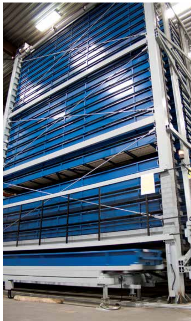
Das halbautomatisierte Rohrlager-System bei Roestvrij BV (Fotos: Roestvrij)
