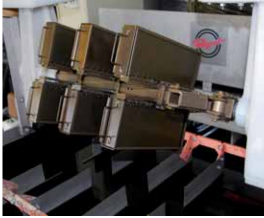
POLIBOX-Anlage mit sechs Kontaktrahmen zum Elektropolieren von Kleinteilen
