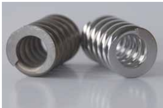
Feder unbehandelt und elektropoliert zur Verbesserung der Dauerfestigkeit
