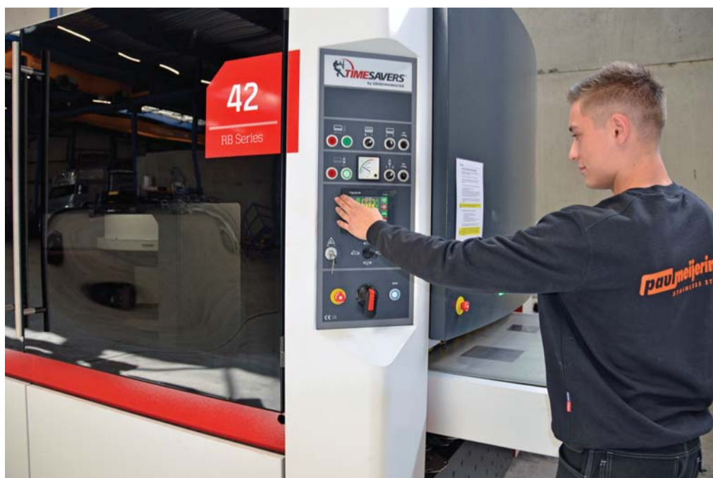
Entgraten, Präzisionsschleifen und Kantenverrunden: Die neue Schleifmaschine macht's möglich.
