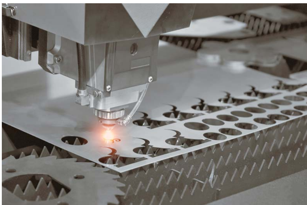
Auch komplexe Konturen lassen sich mit dem Laserschneider leicht anfertigen.
