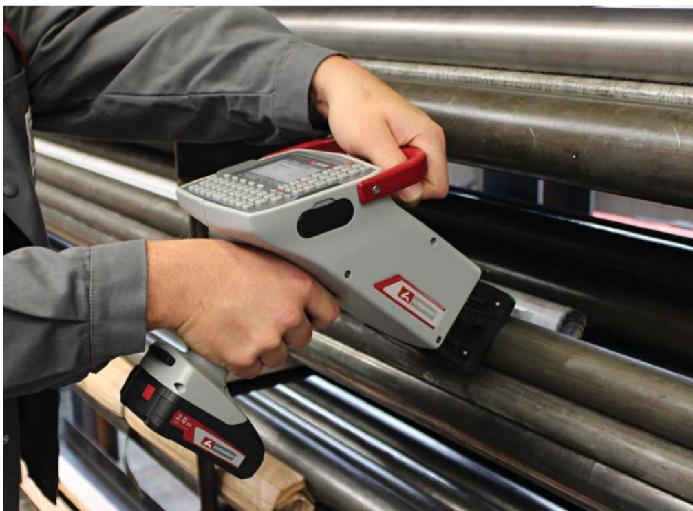
FlyMarker mini markiert Rundmaterial aus Edelstahl. Fotos (6): MARKATOR
