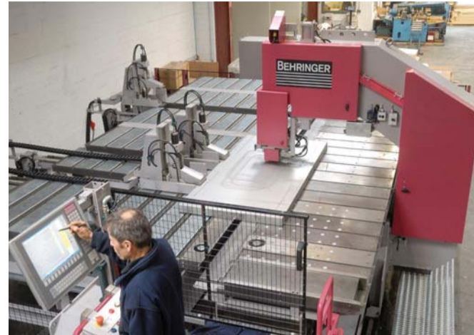
Die vollautomatische Plattensäge mit beweglichem Schneidkopf ermöglicht exakte Zuschnitte nach Kundenwunsch.
