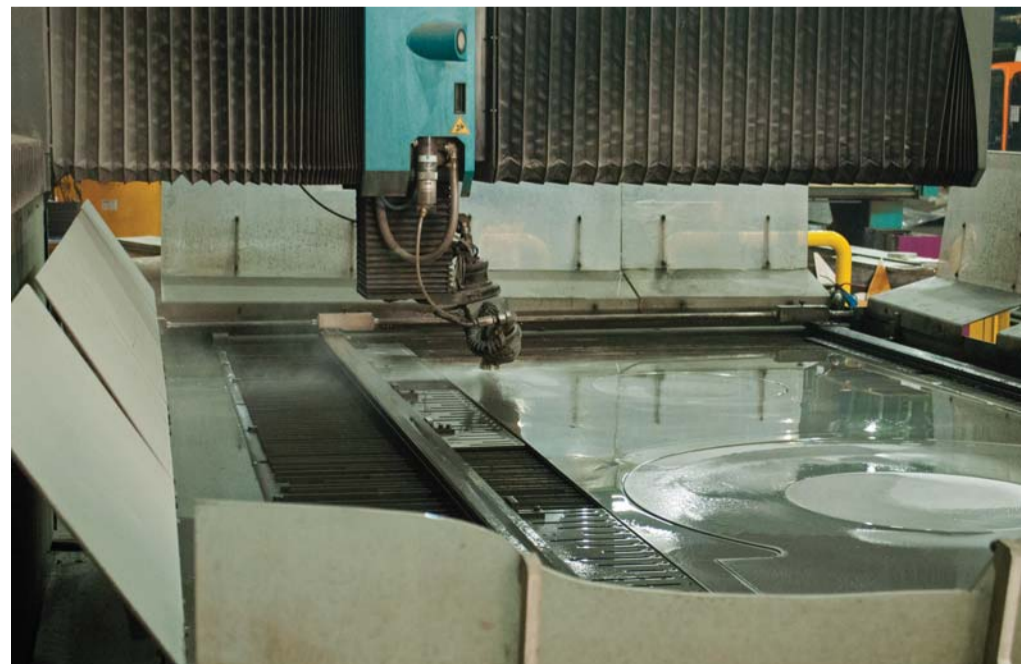
Präzisionsarbeit: Die Wasserschnideanlage erlaubt ein genaues Zuschneiden der Metalle. Foto: Hempel Special Metals GmbH
