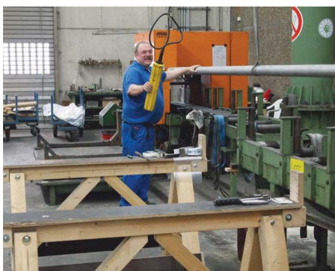
Bearbeitung nach Kundenwunsch: In der Sägemaschine erhält das Rohr die gewünschte Länge.
