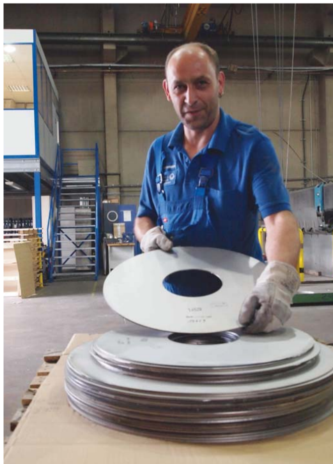
Eine runde Sache: Edeldahlringe der Güte 1.4529, die vor allem für den chemischen Apparatebau verwendet werden.
