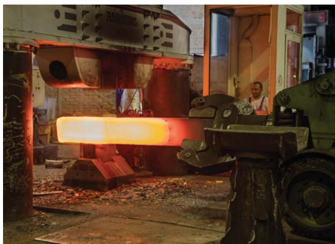
Unterm Hammer: Während des Schmiedens wird der glühende Stahlblock vom Greifarm des Manipulators gehalten.
