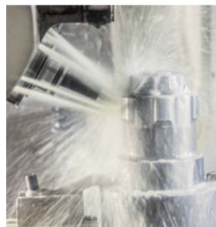
Werkzeugmaschine: 3D-Bearbeitung eines Umformwerkzeugs auf einem 5-Achs-Fräszentrum
