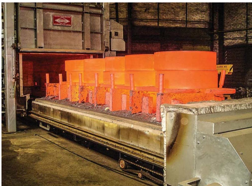
Lösungsglühen von Ringen: Herdwagenofen, Baujahr 2011
