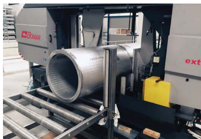
Bomar Metallbandsäge mit einem maximalen Sägedurchmesser von 1.120 mm
