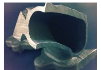
Wanddicken bis 2 mm: Insbesondere in der Automobilbranche ist das Interesse an dünnwandigen Stahlteilen stark wachsend. (Bild: Turboladergehäuse)
