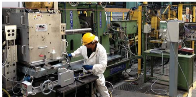
Feinjustierung einer Streufussprüfanlage, mit der geschweißte Rohre kontrolliert werden
