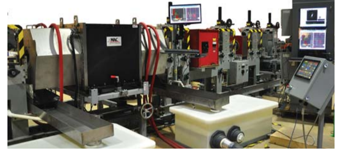
Der kombinierte Einsatz verschiedener Prüfmethode in einer Anlage kann die Ergebnisse verbessern. In diesem Fall werden geschweißte, kaltgezogene Rohre mit Wirbelstrom- und Ultraschallgeräten kontrolliert
