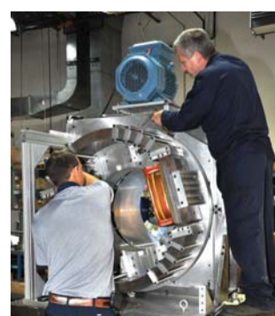
MAC-Techniker montieren die jüngste Version der Rotolux® Streufussprüfanlage, mit der Produkte für die Öl- und Gasindustrie eines Kunden in Russland getestet werden
