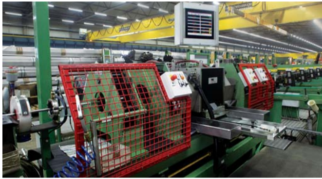
Eine Echomac® Ultraschallprüfanlage kontrolliert geschweißte Wärmetauscher aus Edelstahl und Titan bei den Schoeller-Werken
