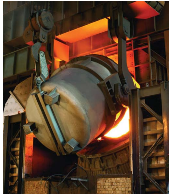
Der 400-Tonnen-Konverter bei ThyssenKrupp Steel Europe wurde gründlich überholt.
