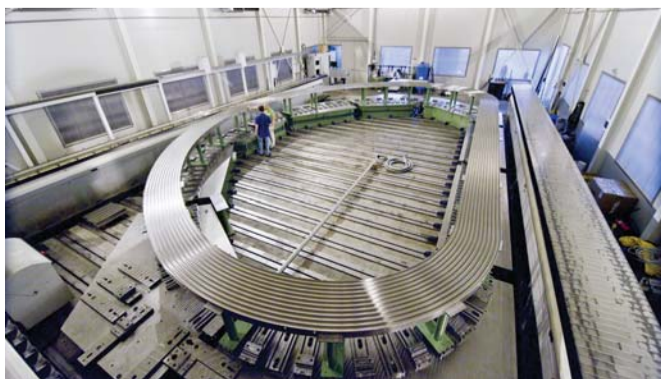
Die Herstellung der 70 D-förmigen Radialplatten für die supraleitenden Magnetspulen erfolgte in Italien
