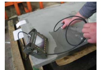
40 Millimeter dicke Schutzplatten aus boriiertem Edelstahl sorgen für den Neutronenschutz. Gefertigt wurden die Bleche in Österreich
