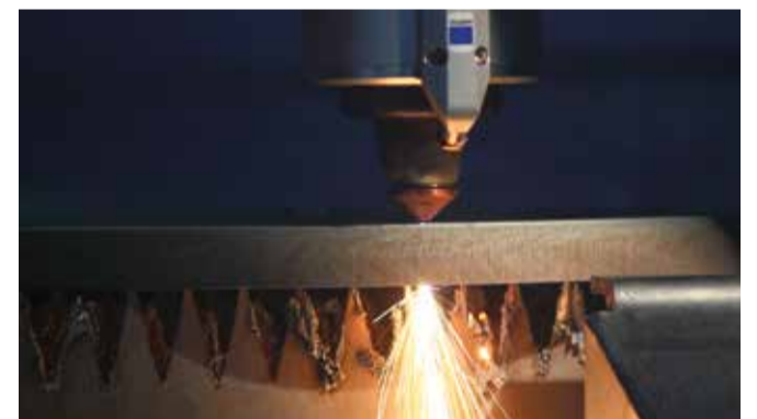
Laserschneiden mit einer Leistung von 7 KW. Foto: Christiane Stücker
