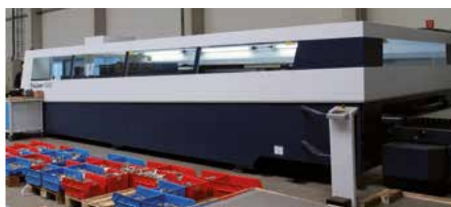
Laserschneiden wird in dem Service-Center mit der Anlage TruLaser 5060 von Trumpf durchgeführt. Foto: Christiane Stücker
