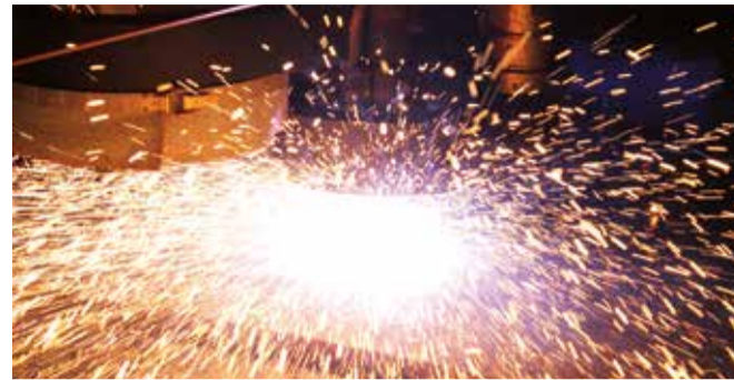
Funkenregen beim Plasmaschneiden über Wasser. Mit der Anlage ist es auch möglich, unter Wasser zu schneiden. Foto: Christiane Stücker
