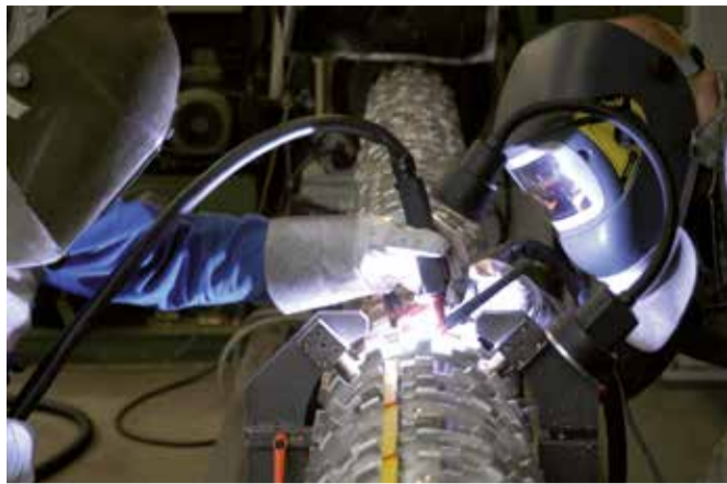
Rohre mit besonderen Form- und Lagetoleranzen: Antriebswalze mit Kettenrad
