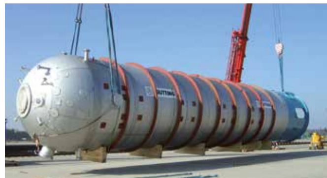
59-t-Druckbehälter aus Werkstoff 1.4162 für Südafrika
